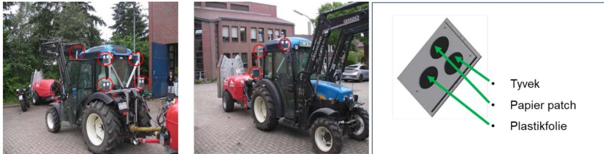
**Abbildung 1:** Hilfsgestell mit installierten Detektorhalterplatten und die Detektorhalterplatten mit eingesetzten Trägermaterialien (rechts)
