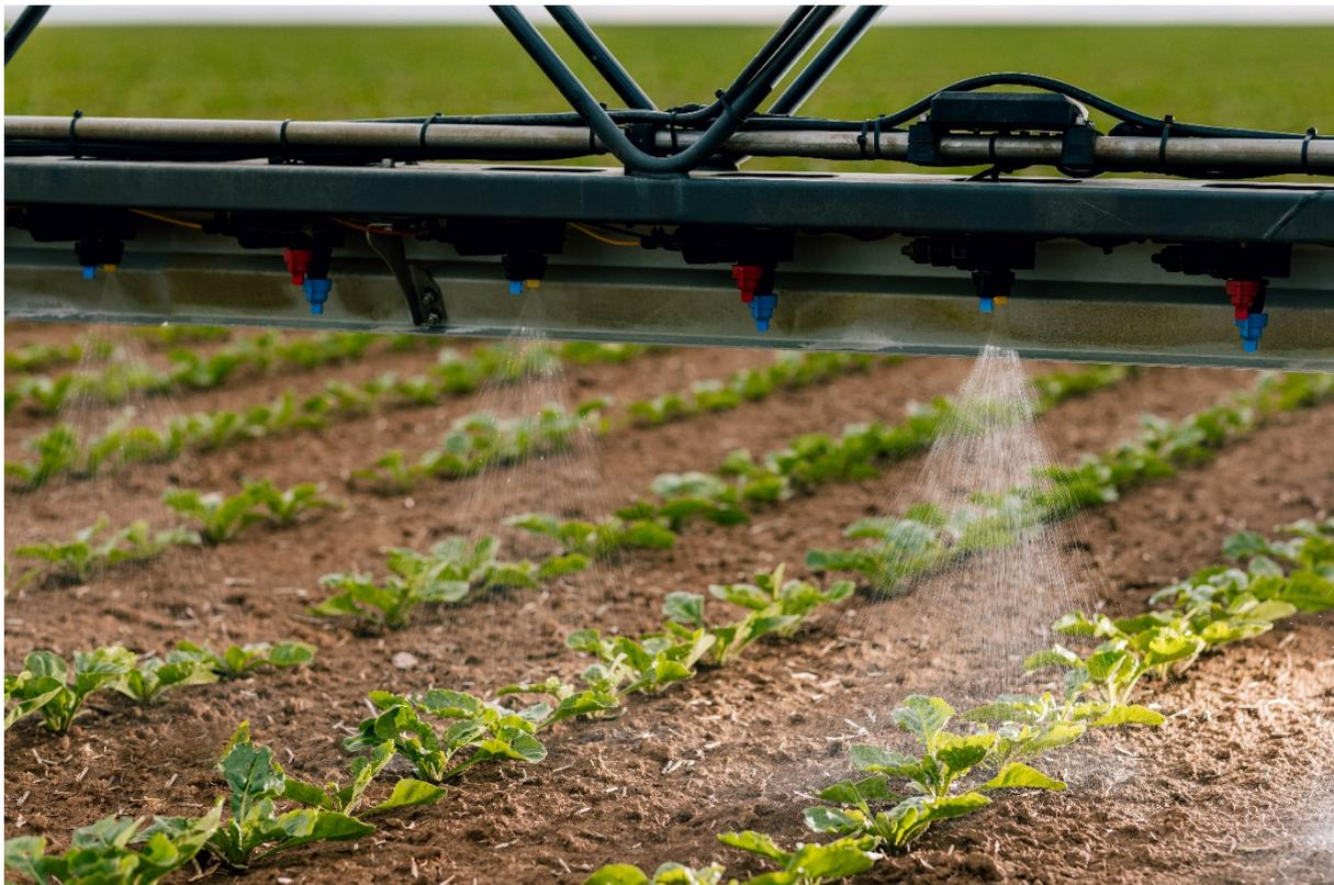
**Abbildung 1:** Streifenspritzung mit einer optimierten Feldspritze
