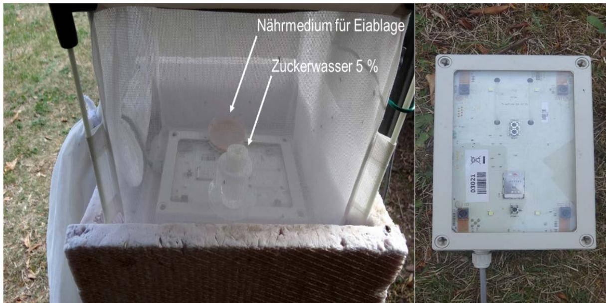
**Abbildung 1:** Aufbau des Kameraversuchs zur Aufzeichnung der Aktivität von *D. sukukii*: Netzkäfig mit Kamera der Firma Trapview (EFOS), Nährmedium zur Eiablage und Gefäß mit 5%igem Zuckerwasser zur Wasserversorgung (links). Kamera der Firma Trapview (EFOS) (rechts).
